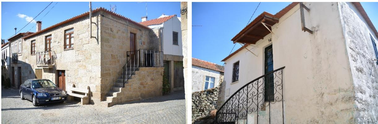
Figura 29: Edifício em alvenaria de granito aparente (Praça Pádua Correia) e edifício em alvenaria de granito rebocado e pintado (Travessa do Outeiro)
