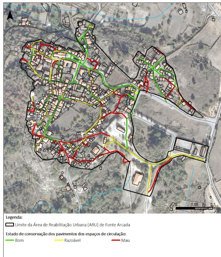
Figura 51 - Estado de conservação dos pavimentos dos espaços de circulação na ARU de Fonte Arcada
